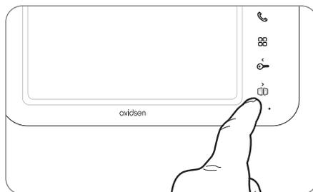
Attention, il est nécessaire que l'écran soit allumé et que la communication audio soit activée pour que les commandes contact sec et sortie alimentée soient opérationnelles. Si l'écran est éteint, il est nécessaire de l'allumer grâce au bouton , puis de faire un appui sur la touche .
