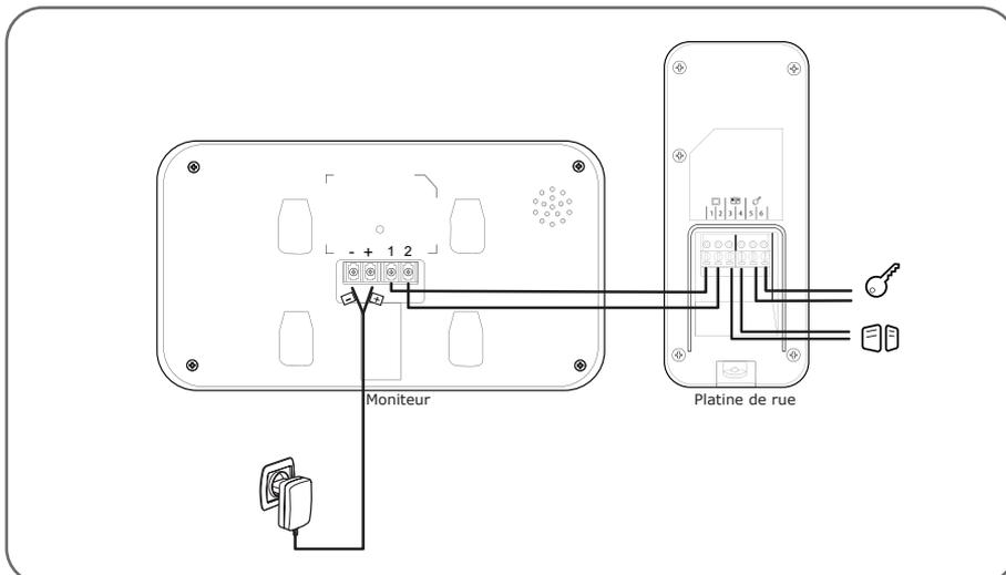
**IMPORTANT** : connectez les borniers 3 et 4 directement au contact d'ouverture/fermeture de la commande automatique (entrée de commande filaire d'une motorisation de portail).
