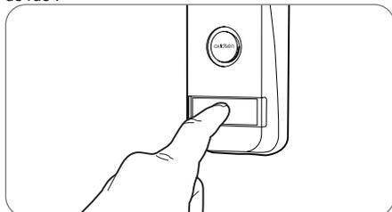
Le carillon se déclenche via le haut-parleur du moniteur qui active la caméra vidéo de la platine de rue. Si le visiteur se situe dans le champ de la caméra, son image apparaîtra sur le moniteur pendant 30 secondes. À la fin des 30 secondes, le moniteur repassera en mode veille.
