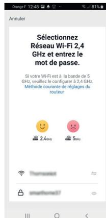
Sélectionnez votre réseau WIFI 2.4GHz (attention, votre smartphone doit être connecté au réseau wifi sur lequel le thermostat va être connecté), insérez votre mot de passe réseau et appuyez sur **SUIVANT**.
