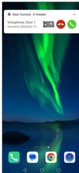
Une capture d'image de la platine de rue apparaît au bout de quelques secondes de sonnerie, vous permettant d'identifier le visiteur. Si vous souhaitez prendre l'appel, cliquez sur le téléphone vert. Le flux vidéo en direct s'affiche sur le smartphone.
