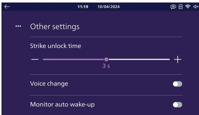
**Strike unlock time (Durée commande gâche)** : vous pouvez ici modifier la durée de commande de la gâche électrique de 1 à 5 secondes.
