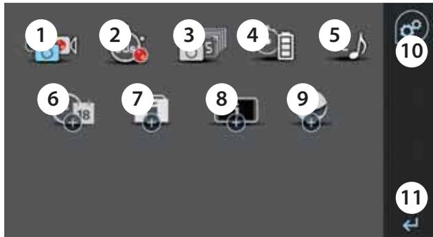
1. Sélectionner la prise de photo (icone photo bleue), l'enregistrement vidéo (icone caméra bleue), ou ni l'un ni l'autre (icônes photo et caméra blanches) en cas d'appel en absence ou en monitoring
