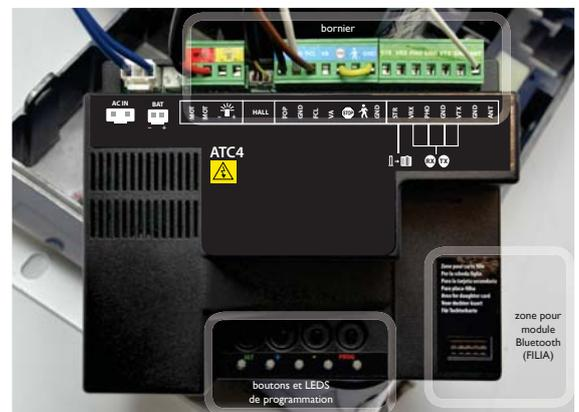
Afin de faciliter le branchement les borniers sont démontables.
