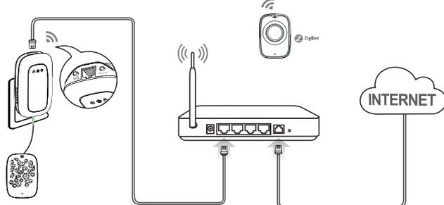
Branchez le câble RJ45 sur votre box internet. Connectez le câble RJ45 sur la base Senso Kit. Connectez le détecteur de température. Branchez la base Senso Kit sur une prise de courant. Installez le détecteur de température sur une surface plane. Installez les piles dans le détecteur de mouvements, la LED bleue clignote. Pour l'appairer avec la base, appuyez 3 secondes sur le bouton (ON).
