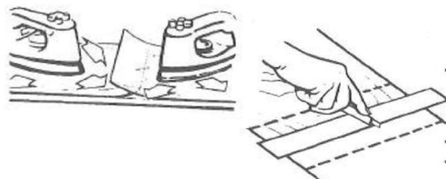
**Jointage** : Convient sur largeur ou longueur. Faire chevaucher les 2 parties à jointer sans les coller. Inciser au centre de la jointure. Retirer l'excédent de placage qui est en dessous. Coller au fer. Si nécessaire, boucher les fentes à la pâte à bois.
