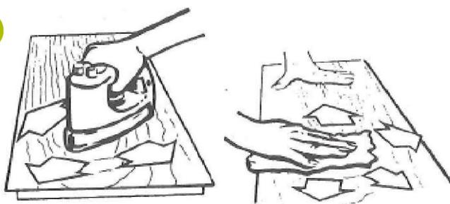
**Collage / Marouflage** : Au fer à repasser ou décapeur thermique. Régler votre appareil sur une chaleur entre laine et soie.
