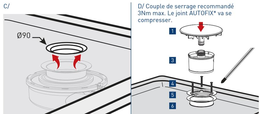
D/ Couple de serrage recommandé 3Nm max. Le joint AUTOFIX\* va se compresser.
