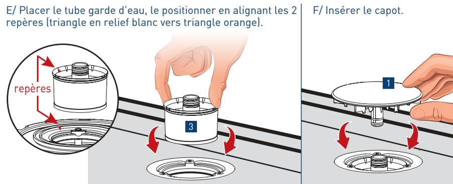
E/ Placer le tube garde d'eau, le positionner en alignant les 2 repères (triangle en relief blanc vers triangle orange).
