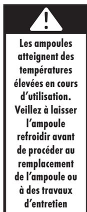
1. Éteignez la lampe (il est préférable d'isoler au niveau du tableau de distribution) puis laissez-la refroidir pendant 10 minutes (Attention : les ampoules atteignent des températures élevées en cours d'utilisation).
