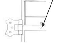
> Percez les pentures aux endroits indiqués avec un forêt de 7 mm. Repositionnez les pentures sur le vantail et revissez.
