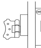
> Tracez les trous de fixation des pentures sur le pilier.
