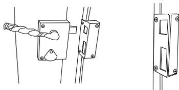
> Tracez les contours de la gâche et ouvrez le vantail pour visser la gâche suivant le tracé.
