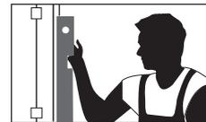
Positionner l'encadrement de porte à la verticale et à l'horizontale à l'aide d'un niveau à bulle.
