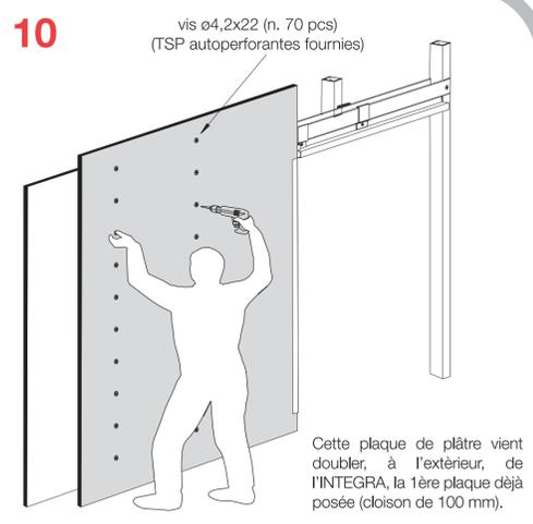
10- Fixer la plaque de plâtre (type BA13) dans les profilés métalliques A4 et A5 à l'aide des vis autopercutantes fournies.
