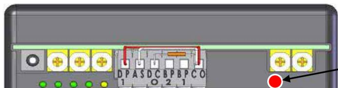
Quand la cellule est occultée ou la barre palpeuse actionnée, la LED rouge (6) sur l'automate INTELLIUS s'allume.
