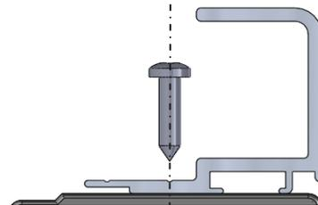
Positionner la vis dans axe rainure
