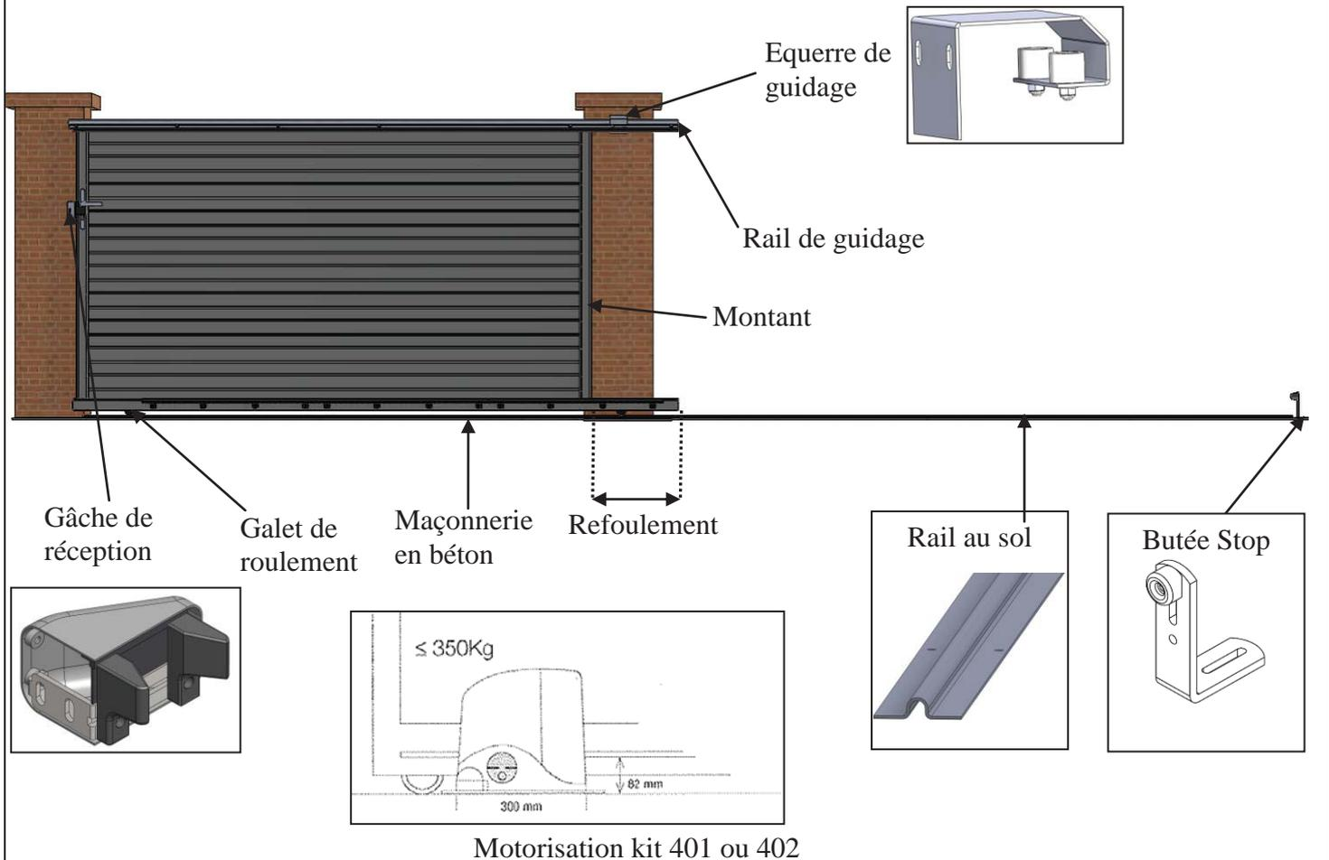
*Exemple d'un portail coulissant à droite vu de l'intérieur (soit un portail commandé en coulissant à gauche vu de l'extérieur)*
