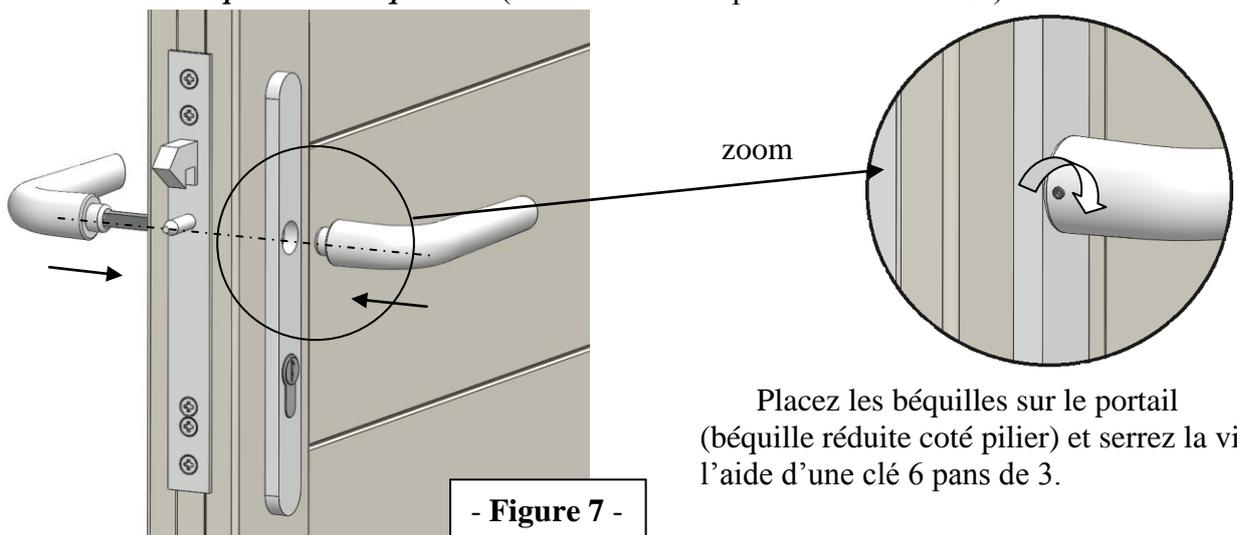
Placez les béquilles sur le portail (béquille réduite coté pilier) et serrez la vis à l'aide d'une clé 6 pans de 3.
