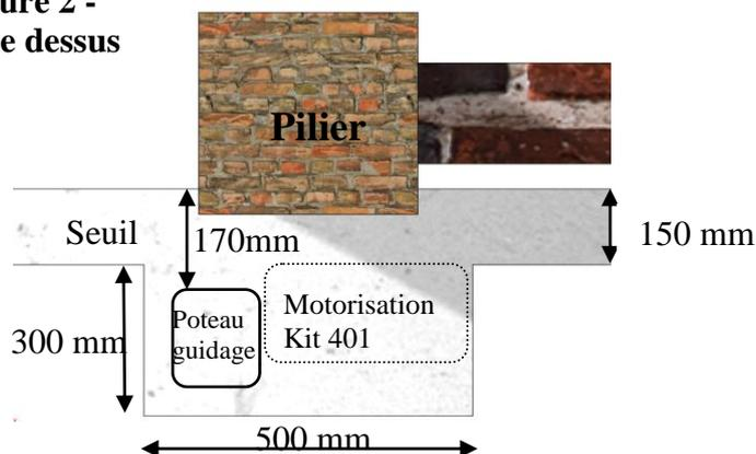
⚠ Prévoir une épargne de  $\approx 110 \times 110$  dans la maçonnerie pour sceller le poteau de guidage.
