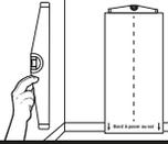
Ce gabarit vous permet une utilisation optimale de votre radiateur sèche-serviettes : meilleure ergonomie et facilité de lecture de l'écran digital sur le boîtier de commande (hauteur à 1,30m)
