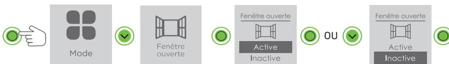
En MODE PROG, la fonction fenêtre ouverte permet de détecter les variations de températures liées à l'ouverture et la fermeture de vos fenêtres. Si vous oubliez d'éteindre votre appareil lors de l'ouverture prolongée d'une fenêtre, cette fonction permet d'y pallier et évite à votre appareil de chauffer inutilement.
