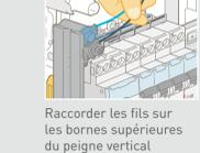
**3** Raccorder les circuits aux disjoncteurs et à la terre
