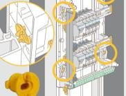
**2** Raccorder la phase et le neutre au disjoncteur d'abonné
