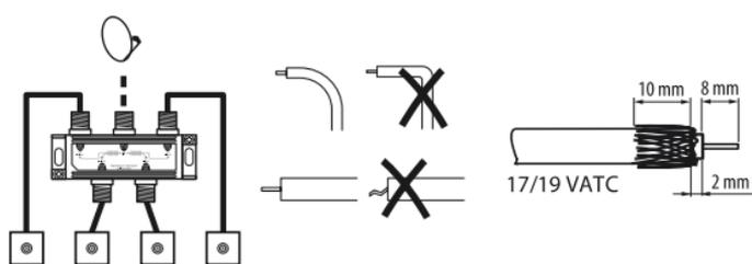
Utiliser un câble coaxial  $\varnothing$  5,5 à 7 mm - 75 $\Omega$
