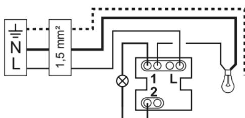
En va-et-vient lumineux, commande de 2 endroits différents.
