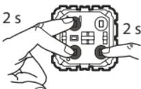
Permet un réallumage systématique au niveau d'éclairage avant la dernière extinction (retour en mode usine).
