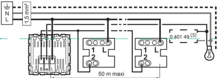
Fonction télérupteur comprise, à ne pas utiliser avec un télérupteur au tableau électrique.
