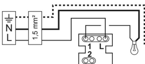
En va-et-vient, commande de 2 endroits différents.
