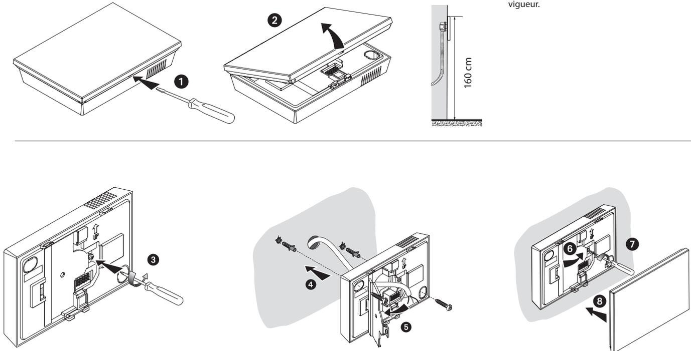
**Attention :** éviter de serrer excessivement les vis pour prévenir les déformations de la base susceptibles de compromettre la bonne installation du dispositif. La partie frontale doit être solidement fixée à la base et le ressort de fixation doit s'engager dans la position prévue à cet effet. Une fois l'installation terminée, attendre 2 heures avant de contrôler la température mesurée.
