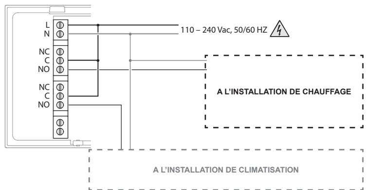
Chauffage et climatisation avec systèmes différents
