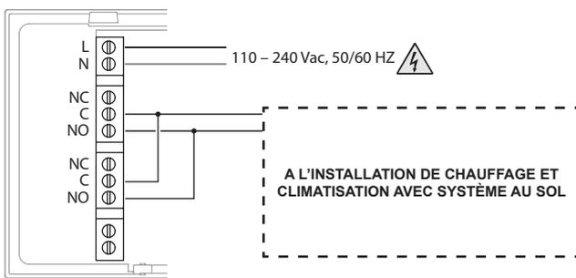
Chauffage et climatisation avec système au sol
