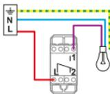
En va-et-vient, commande de 2 endroits différents
