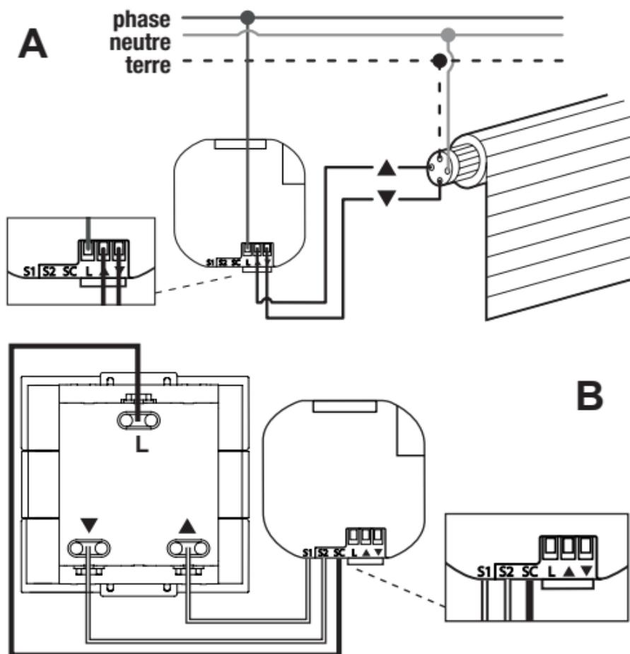
Note: Il est possible d'utiliser le module sans y brancher d'interrupteur. Dans ce cas veillez à isoler électriquement les fils blancs et le fil noir.
