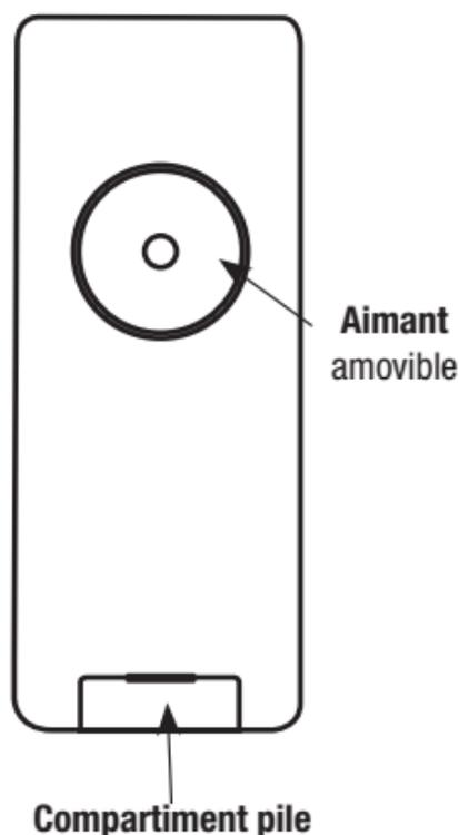
La télécommande possède 16 canaux pour piloter, au choix, 16 récepteurs ou 16 groupes de 10 récepteurs au maximum selon l'environnement, sachant qu'un groupe de 10 récepteurs peut-être appairé sur un même canal.
