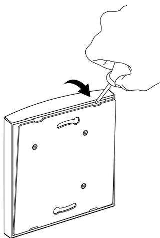
2. Retirer la languette plastique qui dépasse du compartiment pile.
