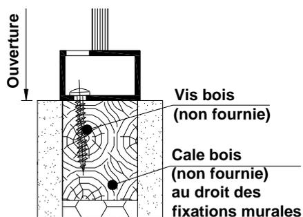
**-Pose sur cloison à ossature métallique**
