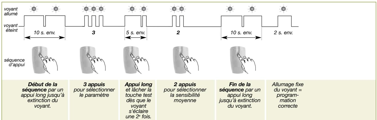
Vérification : la vérification du niveau de sensibilité moyen s'effectue en sélectionnant le n° de paramètre et en contrôlant le nombre de clignotements correspondants.
