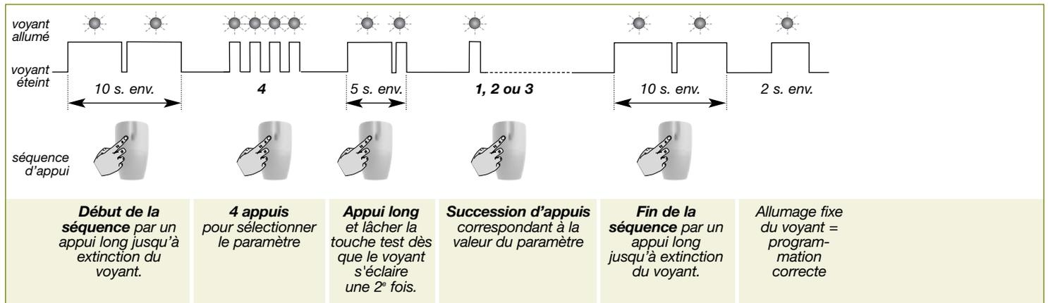
Vérification : la vérification du niveau d'alarme s'effectue en sélectionnant le n° de paramètre et en contrôlant le nombre de clignotements correspondants.
