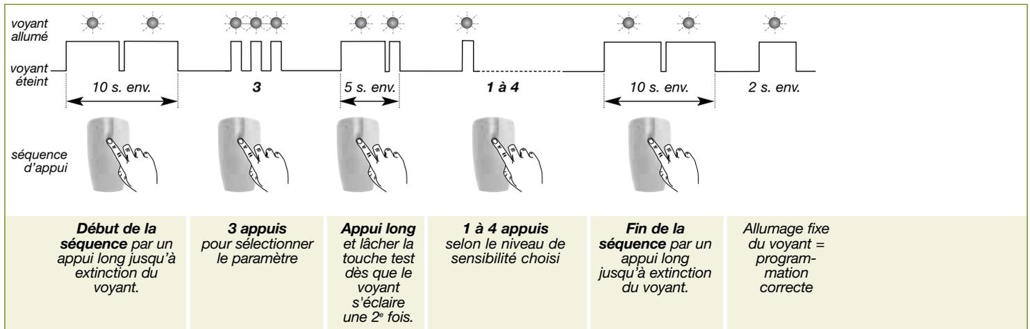
Exemple : réglage pour un niveau de sensibilité moyenne : numéro du paramètre 3, valeur du paramètre 2.
