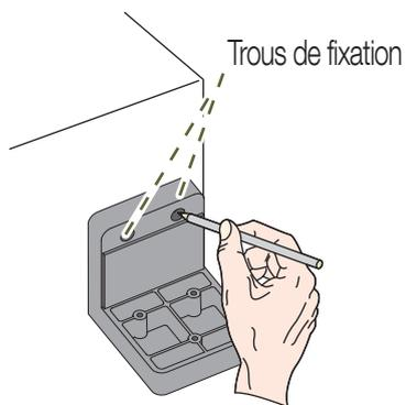
2. Seulement en cas de pilier/mur en **maçonnerie pleine, ou béton, ou acier plein** : retirer le support vertical et percer 2 trous de fixation.
