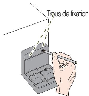
2. Seulement en cas de pilier/mur en **maçonnerie pleine, ou béton, ou acier plein** : retirer le support vertical et percer 2 trous de fixation.
