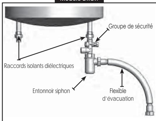
Les groupes de sécurité 34703, 34603, 34702, 32502, 32502B, 32602B, 32702 et 32702B sont équipés d'une garde d'air orientable leur permettant d'être utilisé en configuration droite ou coudée. →
