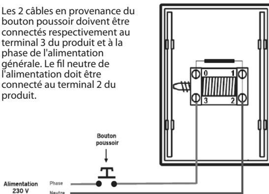
S'assurer que la connexion électrique est correctement réalisée avant d'utiliser le carillon. Le carillon doit être solidement fixé au mur à l'aide des vis et chevilles (fournies)
