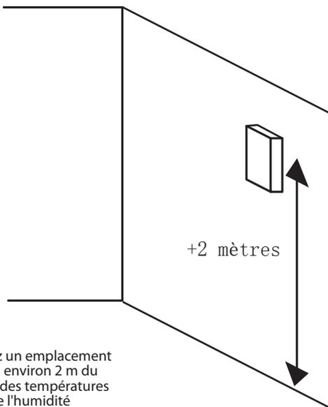
Sélectionnez un emplacement sur un mur à environ 2 m du sol, protégé des températures élevées et de l'humidité
