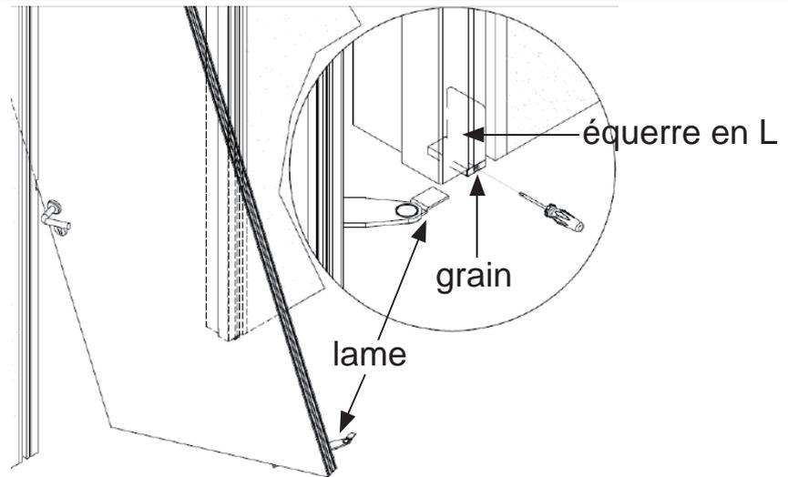
04 Vérifier le bon placement de la lame du bras inférieur dans l'équerre en L. Si nécessaire, serrer le grain à l'aide du tournevis jusqu'à ce que la lame soit complètement bloquée.
