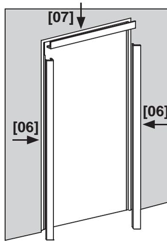
19 Mettre les chambranes verticaux [06] en place en 1<sup>er</sup> puis le chambrane horizontal [07] en tapant légèrement avec la main.
