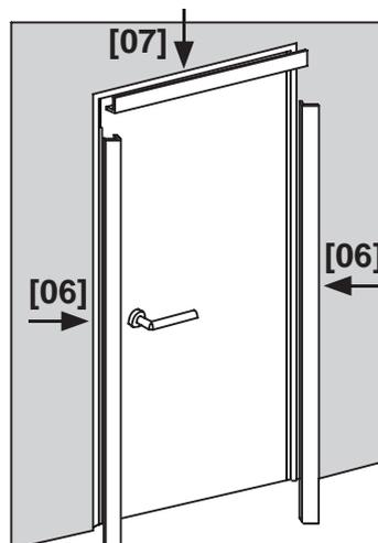
21 Mettre la poignée en place, ouvrir la porte [09] puis mettre les chambranes verticaux [06] restants en place en 1<sup>er</sup> puis le chambrane horizontal [07] en tapant légèrement avec la main.
