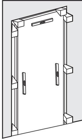
07 Vérifier au moyen du niveau à bulle le bon aplomb dans les 3 dimensions et sur tous les cotés.
