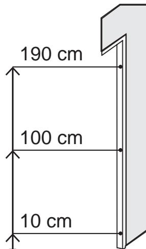
09 Percer les montants verticaux: chaque montant [03] doit être percé en trois points: 10 cm du sol, 100 cm du sol, 190 cm du sol.
