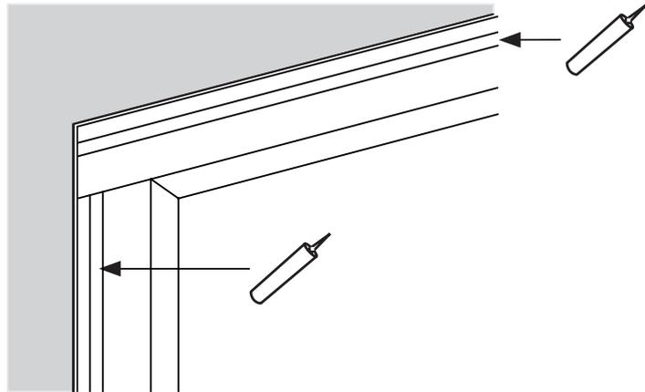
20 Sur l'autre face, mettre quelques points de silicone en fond de feuillure sur montants verticaux [03] et traverse [04] pour parfaire le maintien des chambranes [06][07] avant leur mise en place.
