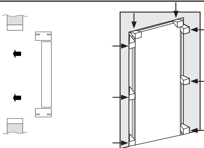
06 Caler le bloc porte en place. Les coins de blocage horizontaux doivent être mis en regard des montant verticaux [03]. Les coins de blocage latéraux doivent être régulièrement espacés les uns des autres.
