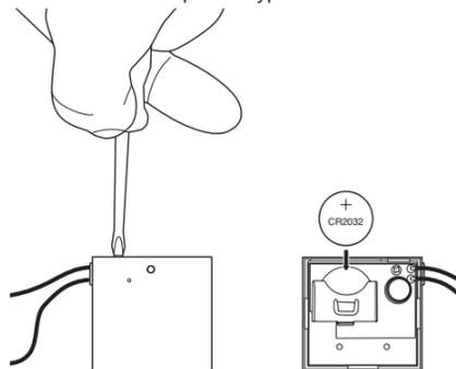
> La durée de vie de la pile est d'environ un an dans le cadre d'une utilisation non intensive.
