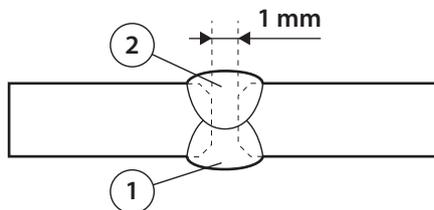
> Pour souder des grandes pièces (>6mm), Réalisez un chanfrein à la lime ou à la meuleuse . Pré-assemblez les pièces par quelques points de soudure tous les 10 cm, puis réalisez les différentes passes selon le schéma ci dessous. Attention à bien enlever le laitier entre chaque passe.
