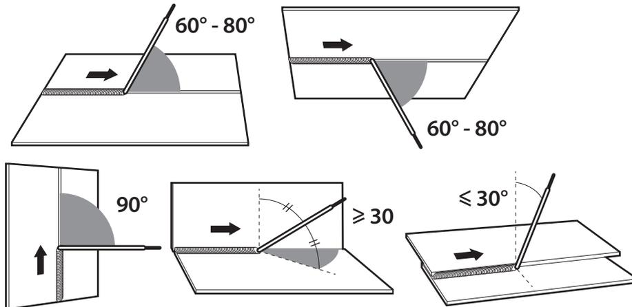
> Pour débuter votre soudure, grattez le bout de l'électrode sur la pièce à souder sur 1 à 2 cm, puis éloignez l'électrode de 2 à 3 mm de la pièce. L'arc s'amorce.
