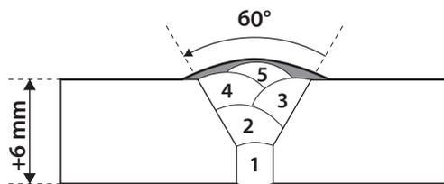
> En fin de soudure, piquez la soudure avec un marteau, puis enlevez la croûte («laitier») qui s'est formée en surface, avec une brosse métallique adaptée.
