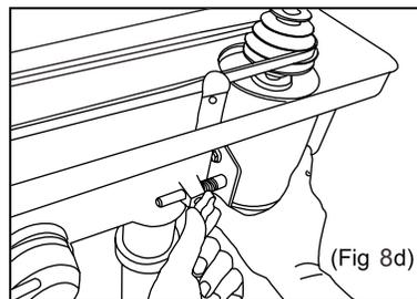
Déplacer la courroie pour le réglage de la vitesse, comme illustré ci-dessous. La poulie à droite comme illustré ci-dessous relie l'arbre de sortie du moteur.
