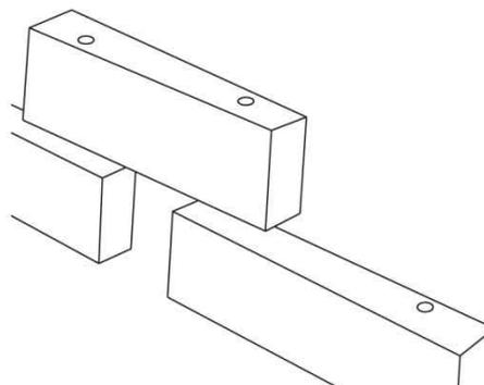
Commencez à construire votre cloison en insérant les tourillons dans les trous percés à cet effet, en emboîtant les briques les unes au dessus des autres.
