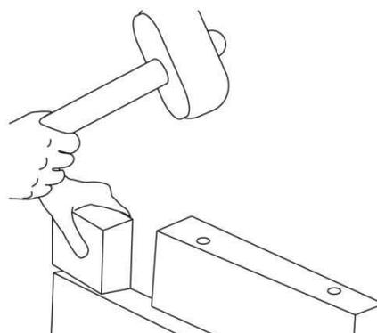
Les briques de 11 cm de long doivent être utilisées sur les côtés de la cloison pour harmoniser les extrémités de la cloison.
