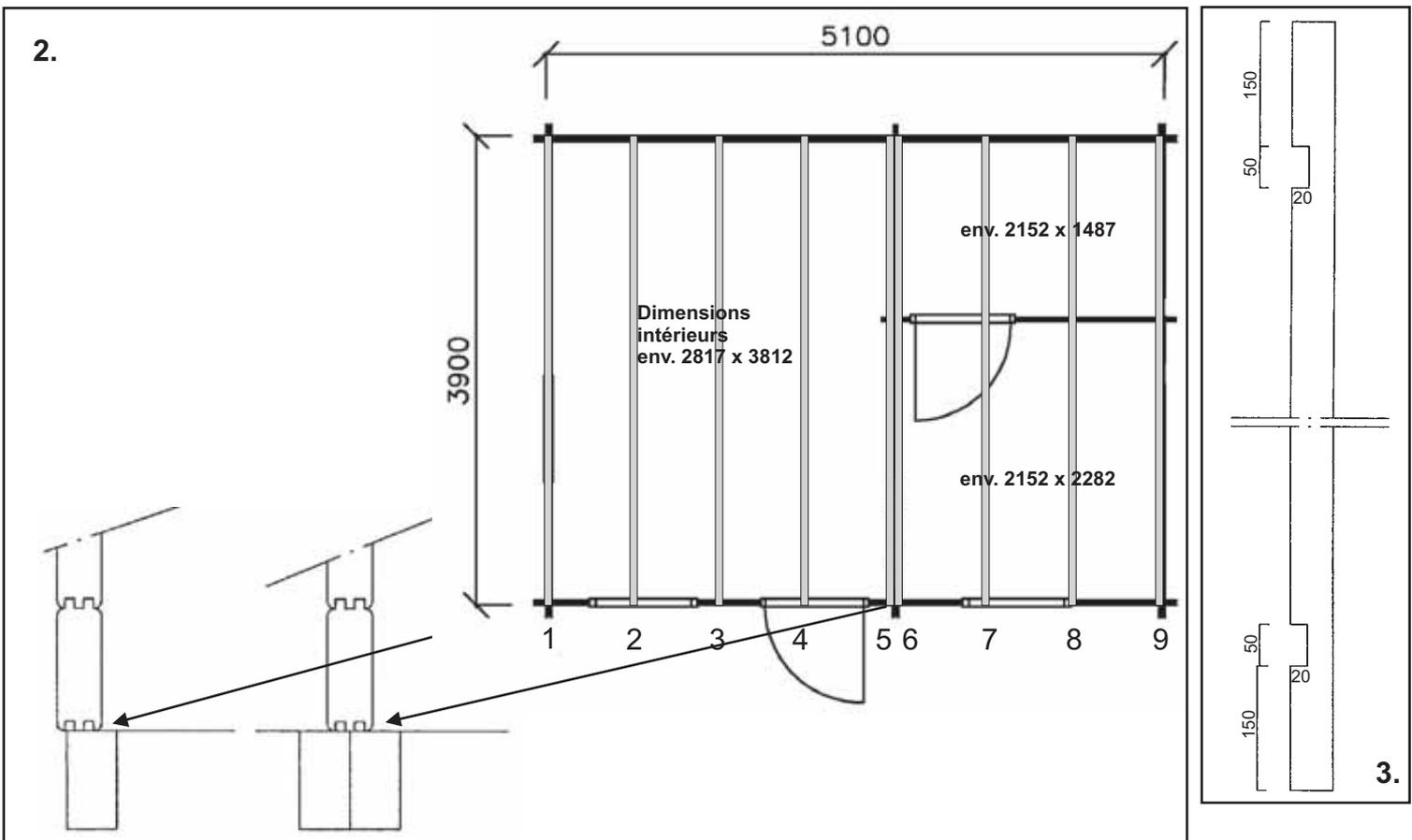
Commencez par installer les 9 solives à intervalles réguliers au mur de côté, figure 2. Remarque: placez les deux solives extérieures suivant la figure 3 vue de dessus (les trous percés dirigés vers le haut pour les tiges filetées).
