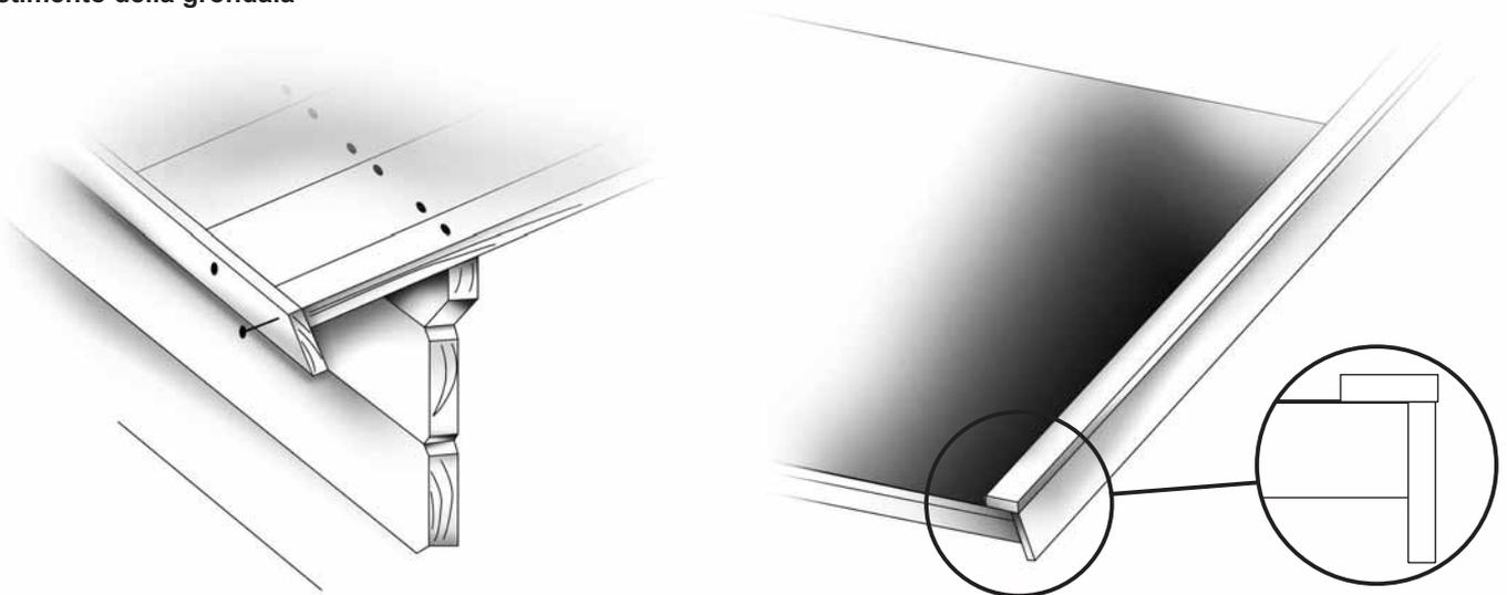
**14. Palahuovan asentaminen - Installing roofing shingles - Montering av takplattor - Montering af shingles-plader -
