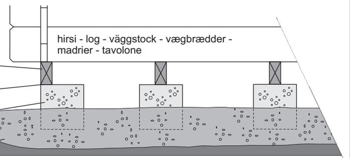
**4. Hirsien asennussuunta, perustuspuiden asettelu ja lattian kiinnitys - The assembling direction of logs, foundation beams and assembling of the floor - Monteringsdirektion av väggtimren, grundbalkarna och montering av golvet - Vægbrædderne, fundamentbjælkerne og montering af gulvet - La pose des solives et la fixation du plancher - La posa delle travi di fondazione**
