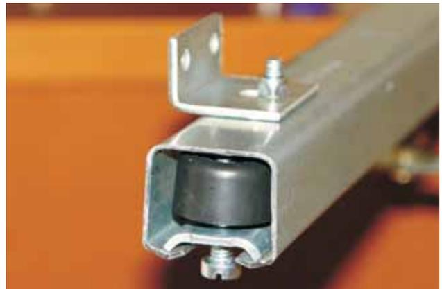
Ensuite installez la barre de fixation T6 pour le rail coulissant au-dessus de l'ouverture de la porte (photos 3 et 4) avec des vis 4x40mm (5 vis), de manière à ce que la distance entre T5 et T6 soit d'environ 1740mm. Fixer les supports du rail sur le rail avec des vis et contre-écrous. Posez deux pièce de bloque porte en caoutchouc à l'intérieur du rail (les deux autres seront posés après avoir installé les portes).
