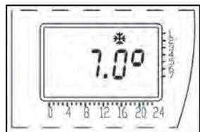
Enfoncer le bouton FONCTIONS (☺️) pour passer à la fonction HORS GEL (❄️). Le radiateur continue à fonctionner à une température de 7°C sans limite dans le temps. Aucun réglage n'est possible. Toutes les commandes FIL-PILOTE sont désactivées à l'exception du STOP.
