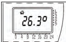
FONCTIONS (🏠) jusqu'à affichage du symbole (🏠). Toutes les fonctions du radiateur (CONFORT, NUIT, HORS GEL, PROGRAMMATION, STAND-BY,) seront directement commandées par la centrale Fil-Pilote. Le contrôle accepte six ordres: CONFORT, REDUCTION (température CONFORT -  $3,5^{\circ}\text{C}$ ), STOP, HORS GEL ( $7^{\circ}\text{C}$ ), ECO1 (température CONFORT -  $1^{\circ}\text{C}$ ), ECO2 (température CONFORT -  $2^{\circ}\text{C}$ ).
