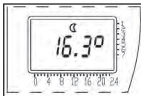
Enfoncer le bouton FONCTIONS (☺️) pour passer à la fonction NUIT (🌙). La température de réglage est celle configurée. Pour régler le niveau de température désiré, enfoncer la touche (+) pour augmenter la température, et la touche (-) pour la diminuer. Toutes les commandes FIL-PILOTE sont désactivées à l'exception du STOP.
