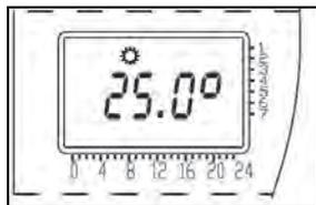
Enfoncer le bouton On/Stand-by (☉) la centrale s'allume sur la fonction CONFORT (⚙️). La température de réglage est celle configurée. Pour régler le niveau de température désiré, enfoncer la touche (+) pour augmenter la température, et la touche (-) pour la diminuer. Toutes les commandes FIL-PILOTE sont désactivées à l'exception du STOP.
