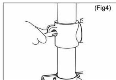
5. Vissez la manette de réglage de la hauteur et serrez-la au moyen d'une clé hexagonale (Fig5)
