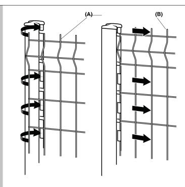
Emboiter et fixer le 1er panneau dans les encoches du poteau. Picots vers le hauts >=1,53m
