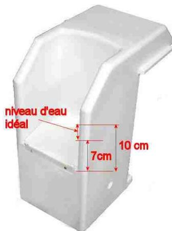
**Votre niveau d'eau doit toujours être suffisant pour un bon fonctionnement de votre filtration. Entre 7 et 10 cm au dessus de la base de votre volet de skimmer**
