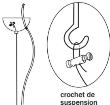
Cet accessoire est conçu avec un isolement renforcé. Il n'a pas besoin d'être mis à la terre.
