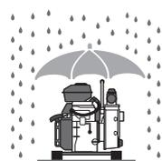
Ne pas utiliser la motopompe sous la neige ou la pluie, ainsi que des projections d'eau. Ne pas la manipuler avec les mains/pieds mouillés ou moites. Ne pas utiliser « pieds nus » sous peine de risques d'électrocution. Ne jamais diriger un nettoyeur haute pression vers la motopompe sous peine de choc électrique.
