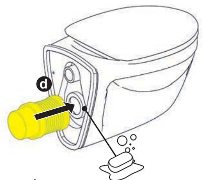
Insérer le manchon d'évacuation extensible [03] sur la sortie de la cuvette. Lubrifier la sortie de la cuvette pour faciliter l'insertion.
