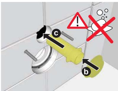
Positionner le joint de cuvette [05] sur la manchette [04] et insérer partiellement la manchette dans le tube de descente.
