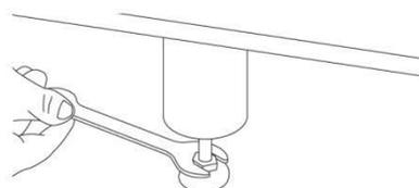
Insérer les pieds dans les chevilles appropriées. Mettre la cloison en pression entre le sol et le plafond en bloquant les pieds à l'aide de l'écrou serré avec la clé. Ajuster les cylindres cache-pieds 8cm en fonction de la hauteur des pieds.
