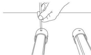
Placer les cylindres de 10cm pour aligner le bord du montant avec le bord du cylindre et visser à l'aide des 4 vis.
