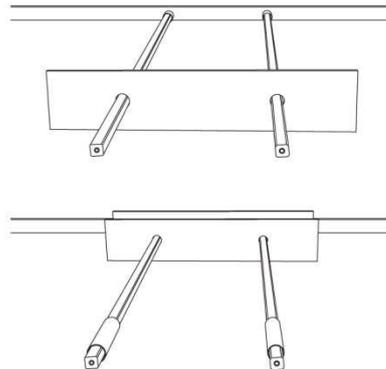
Enfiler ensuite les tablettes et les autres cylindres (sauf 10cm) en vous assurant de bien mettre en face les cylindres de même hauteur puis finir par les cylindres de 10cm et vissez-les comme dans la 1ère étape en veillant à bien aligner encore le bord du montant avec le bord du cylindre.
