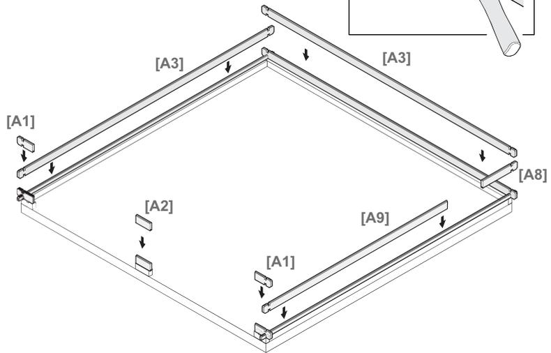
Veillez à ce que la structure se monte symétriquement. En d'autres termes, l'emboîtement d'un madrier doit être au centre du madrier perpendiculaire.
