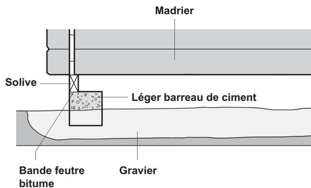
Dans ce cas, la qualité de rangées des plots doit être identique au nombre de solives. L'espacement entre les piliers est déterminé par l'épaisseur des solives :
